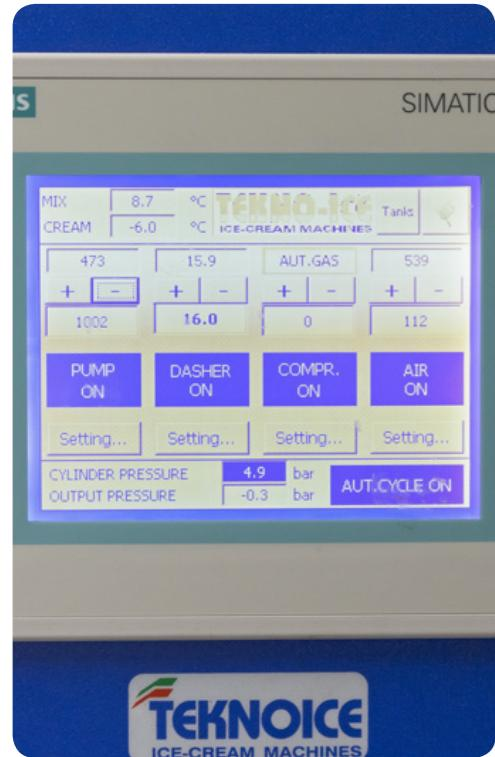
Dal pannello elettronico con quadro "touch screen" (nella versione elettronica EL) è possibile mettere in funzione e controllare le seguenti fasi e relativi parametri funzionali:
